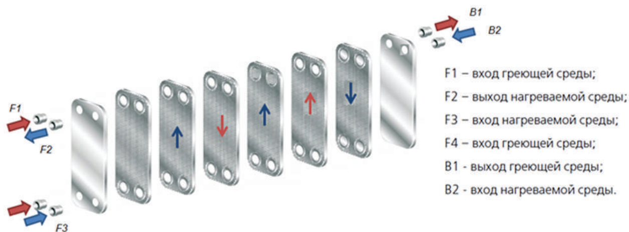
Рисунок А.4 — Пакет пластин и схема потоков рабочих сред в нем (двухходовая компоновка, моноблок)
